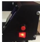
6. Нажмите кнопку "RESET" чтобы обнулить таймер
