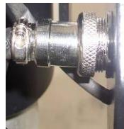
Открутите барабашковую гайку при помощи которой крепится насадка, замените на нужную вам насадку и зафиксируйте с помощью гайки
