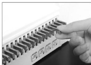
Рис. 2 Для нестандартной перфорации документа отключите ненужные ножи пробива
