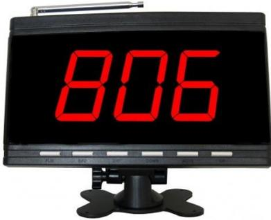
Стационарный приемник (табло), который по очереди выводит на экран до 10 вызовов включительно. При этом каждый из них обозначен при помощи трех буквенно-цифровых символов. Легко устанавливается на стол при помощи подставки или крепится на стену саморезами. Стильное функциональное устройство, обеспечивающее стабильный прием вызовов благодаря встроенной антенне.
