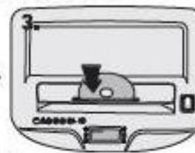
Вставьте пластиковую карту в проем загрузки. Аппарат включится автоматически и начнет работу.
