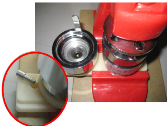
Установите салазки, зафиксировав по бокам штифтами
