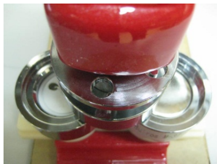
Установите салазки, зафиксировав по бокам штифтами
