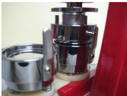
Салазки, двигаясь вправо/влево, смещают верхнюю насадку по оси, изменяя ход клише при сжатии
