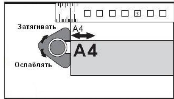
**ШАГ 2 :** Настройка глубины пробивки
