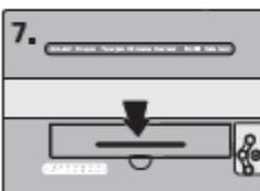
7. Для удобства извлечения документа откройте защитную крышку. Очистив рабочую зону, закройте крышку.
