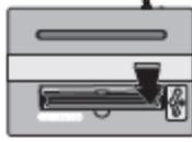
Нанесите смазочную жидкость
