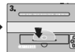
3. Вставьте пластиковую карту в проем загрузки. Аппарат включится автоматически и начнет работу.
