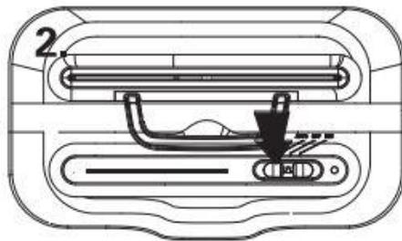
2. Включите аппарат, индикатор «Auto» загорится зелёным светом, аппарат готов к работе
