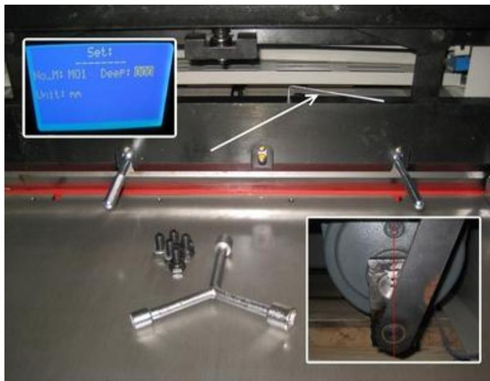
В данном методе достаточно соприкосновения кромки ножа с марзаном. Прикрутите сверху торцевые регулировочные винты (**Balance screws**) вплотную к телу ножа без усилия, создавая для него упор.
