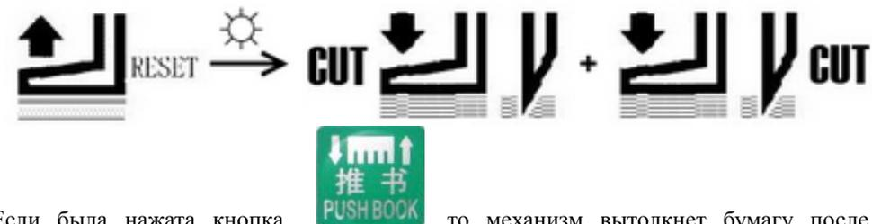
Если была нажата кнопка
