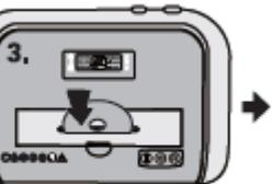
Вставьте пластиковую карту либо CD/DVD-диск в проем загрузки. Аппарат включится автоматически и начнет работу.
