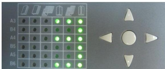
Включение этого режима осуществляется одновременным нажатием кнопок «Влево» / «Вправо»; эти же кнопки служат для перехода между вариантами **1 - 6**, а выход к **стандартным положениям** происходит нажатием кнопок «Вверх» или «Вниз».
