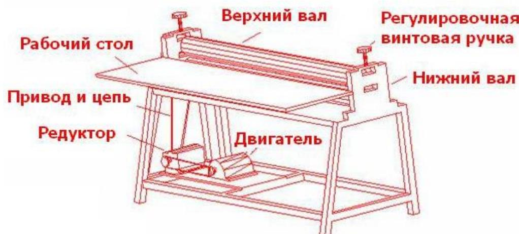
Машина состоит из верхнего и нижнего вала, верхнего и нижнего уступа (подставки), приводов, колеса ,цепи, приводного ремня, редуктора и регулировочного винтового механизма .
