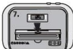
7. Для удобства извлечения документа откройте защитную крышку. Очистив рабочую зону, закройте крышку.
