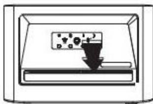
Нанесите смазочную жидкость
