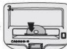
Вставьте пластиковую карту в проем загрузки. Аппарат включится автоматически и начнет работу.
