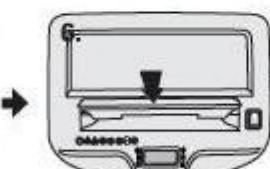
Для удобства извлечения документа откройте защитную крышку. Очистив рабочую зону, закройте крышку.
