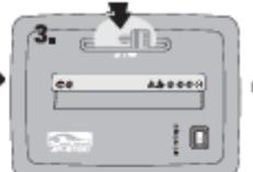
Вставьте пластиковую карту либо CD/DVD диск в проем загрузки . Аппарат начнет работать автоматически
